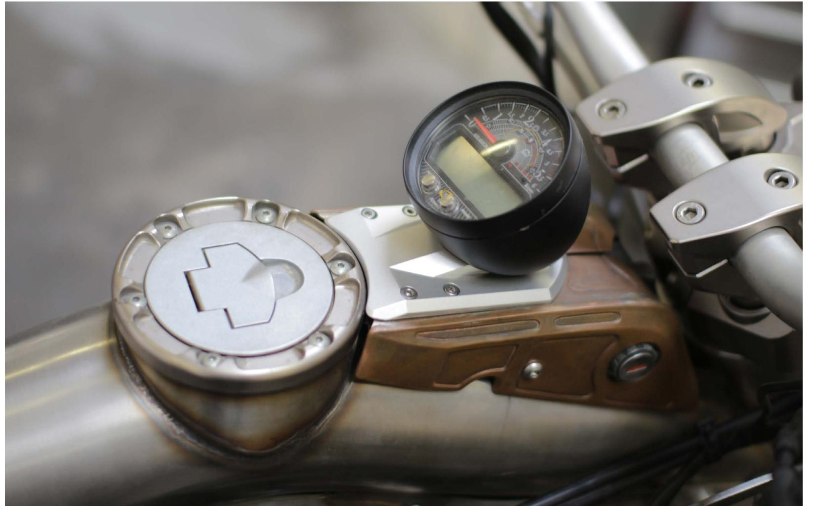
*Fig. 94: Modello finale di base per contachilometri elaborato in alluminio ricavato dal pieno per CR&S DUU REDSHIFT da Archivio Given Motodesign*
