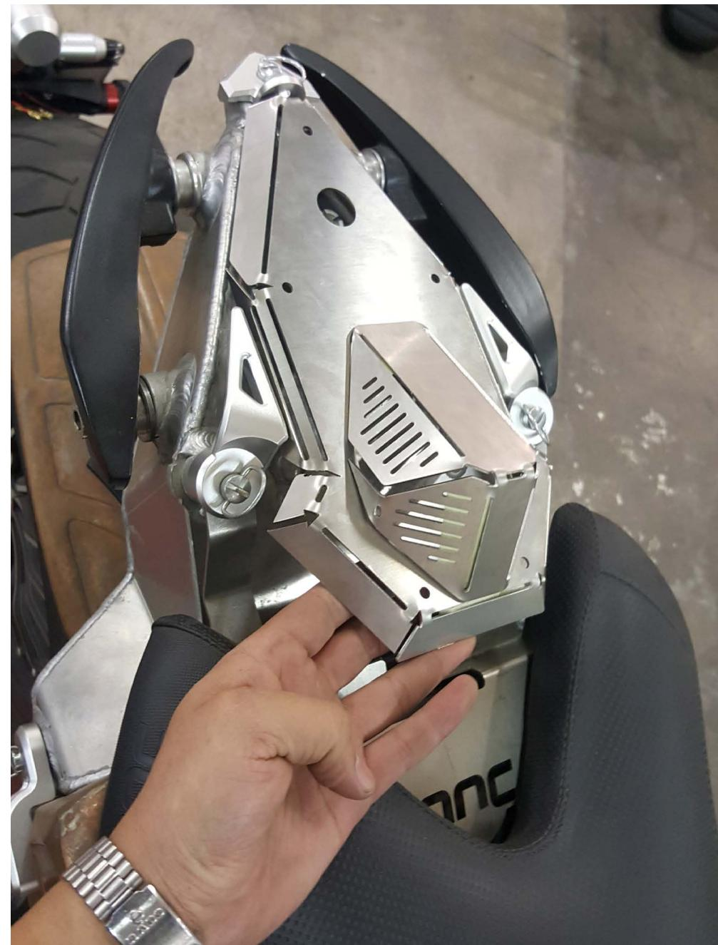
Fig. 87: Lamiera di acciaio inox piegata prima di saldatura posizionata con ganci di sella ribaltabile monoposto per CR&S DUU REDSHIFT da Archivio Personale
