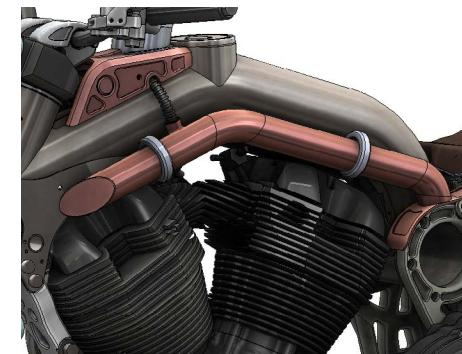
Fig. 65 Tubi per componenti elettrici
