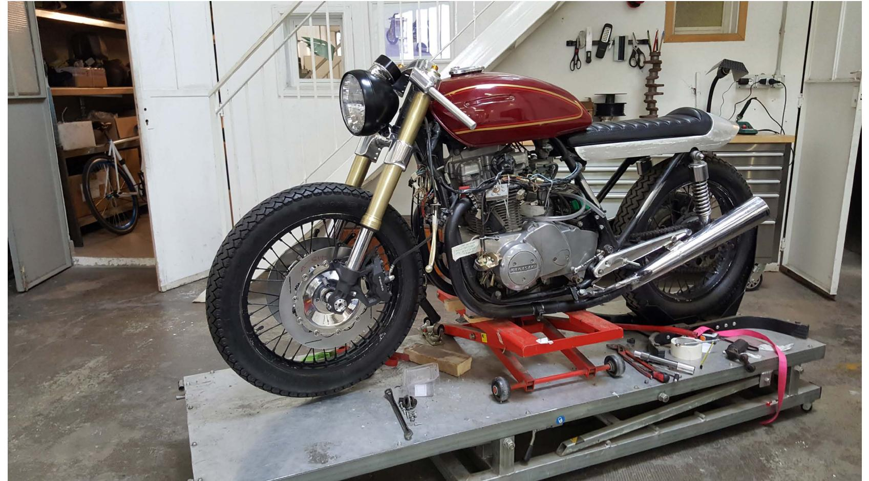
*Fig. 31: Kawasaki Z750B con piastre forcelle e piastre pedane ricavate dal pieno con tecnologia CNC da Archivio Given Motodeign*
