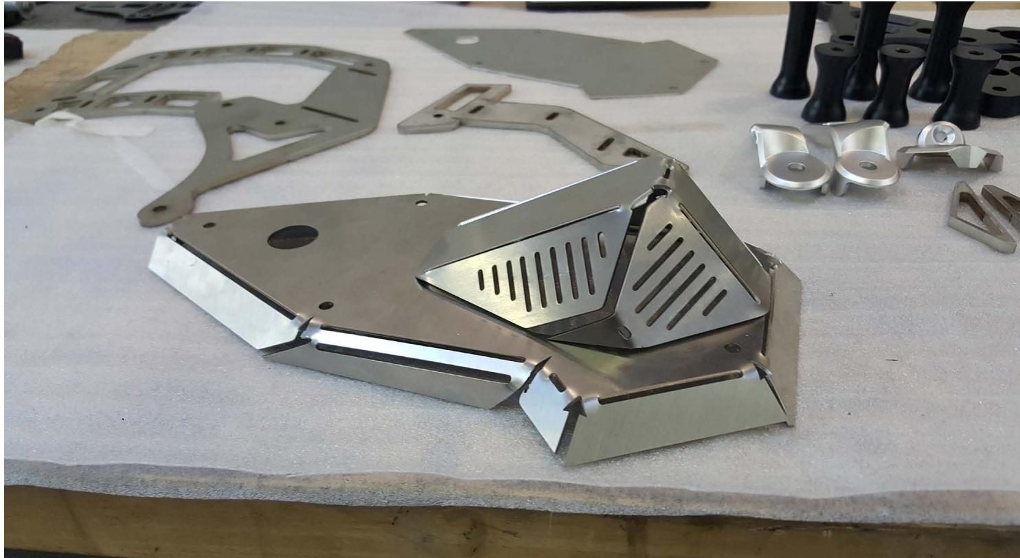
*Fig. 86: Lamiera di acciaio inox piegata prima di saldatura di sella ribaltabile monoposto per CR&S DUU REDSHIFT da Archivio Given Motodesign*
